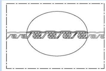
Abriebfester, ölbeständiger und mit Polyurethan ummantelter Metall-Schutzschlauch; extrem robust und flüssigkeitsdicht; doppelt gefalztes Metallprofil
